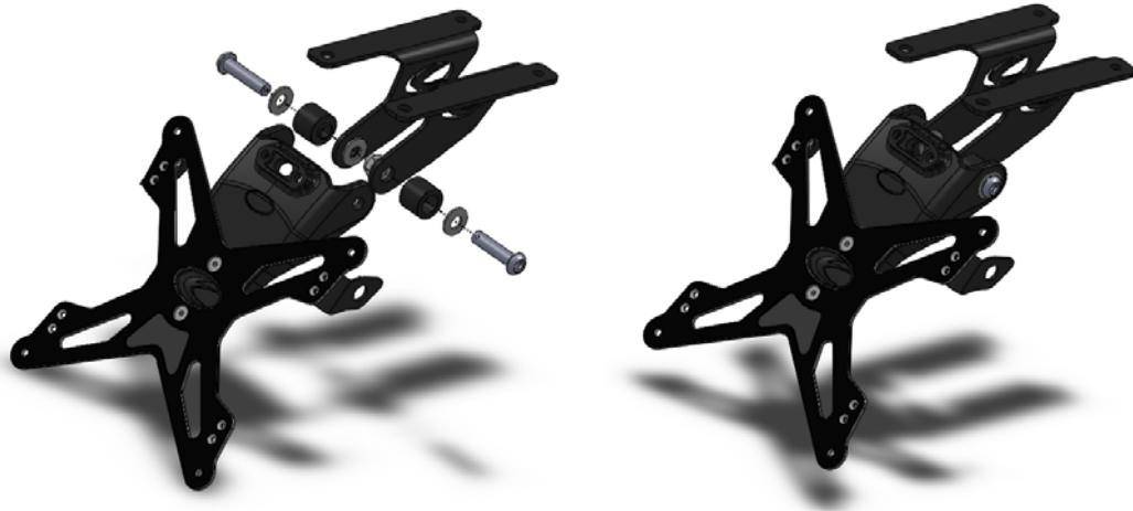
**3)**Fissare il gruppo precedentemente montato sotto il codone della moto attraverso i 4 bulloni M6 indicati nella vista esplosa, facendo passare eventuali cavi elettrici dei dispositivi di illuminazione. Interporre tra le staffe e il codone della moto, sulla parte anteriore della moto, le due boccole fornite. Imprimere per i bulloni M6 una coppia di serraggio pari a 9Nm.
